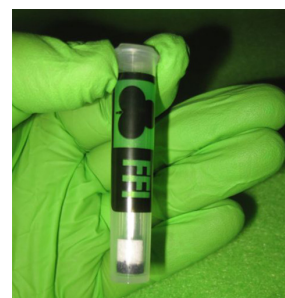
Exemple de test positif au chlorate, l'embout passe du blanc au bleu foncé.
