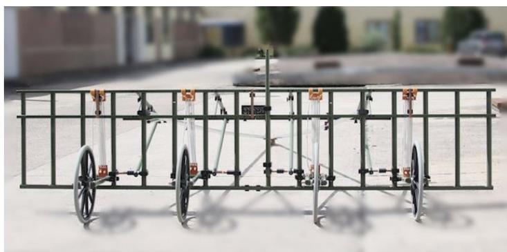
Equipé d'un D-GPS RTK, le système MX V3 offre une précision de positionnement de ± 1 cm pour chaque point de mesure. La station GPS mobile est montée sur le véhicule, tandis que la station GPS de base (point de référence) est située à proximité de la zone de mesure.
